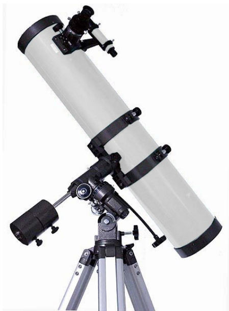
Abbildung 60: Teleskop mit parallaktischer Montierung. Mit freundlicher Genehmigung von Wolfgang Ransburg
