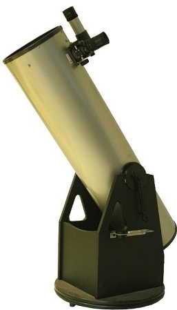
Abbildung 59: Dobson-Teleskop. Mit freundlicher Genehmigung von Wolfgang Ransburg
